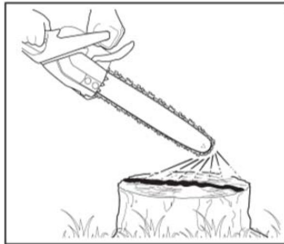
Tritt kein Öl aus, prüfen Sie, ob sich Öl im Öltank befindet, und vergewissern Sie sich, dass die Schraube und die Bohrungen frei von Schmutz sind. Reinigen Sie auch den Bereich rund um den Ölauslass hinter dem Schwert am Gerät.
